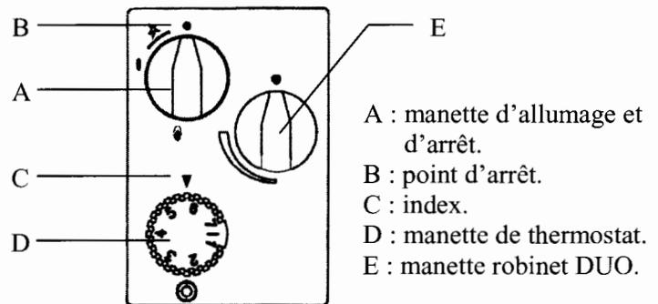
Si vous fermez ce robinet, le thermostat contrôle alors, complètement, le fonctionnement de l'appareil et arrête le brûleur arrière si la température est assez élevée.
