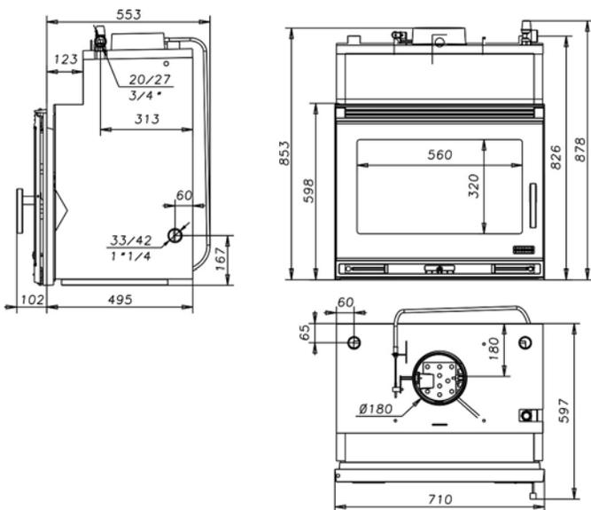
**Note :** Le schéma côté ne tient pas de l' isolation de l' insert.
