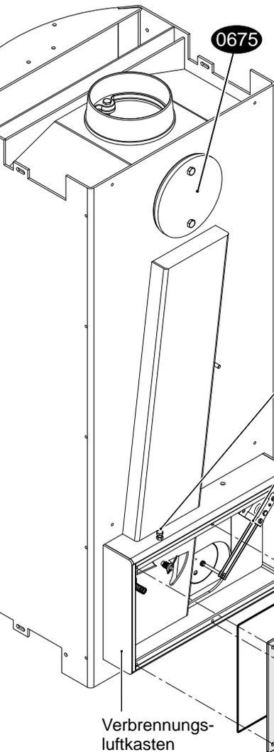
Schraube mit Kontermutter zum Verstellen des Sekundärluftschieberanschlags
