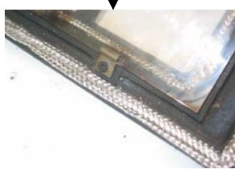
Détail porte - joint et fixation vitre
