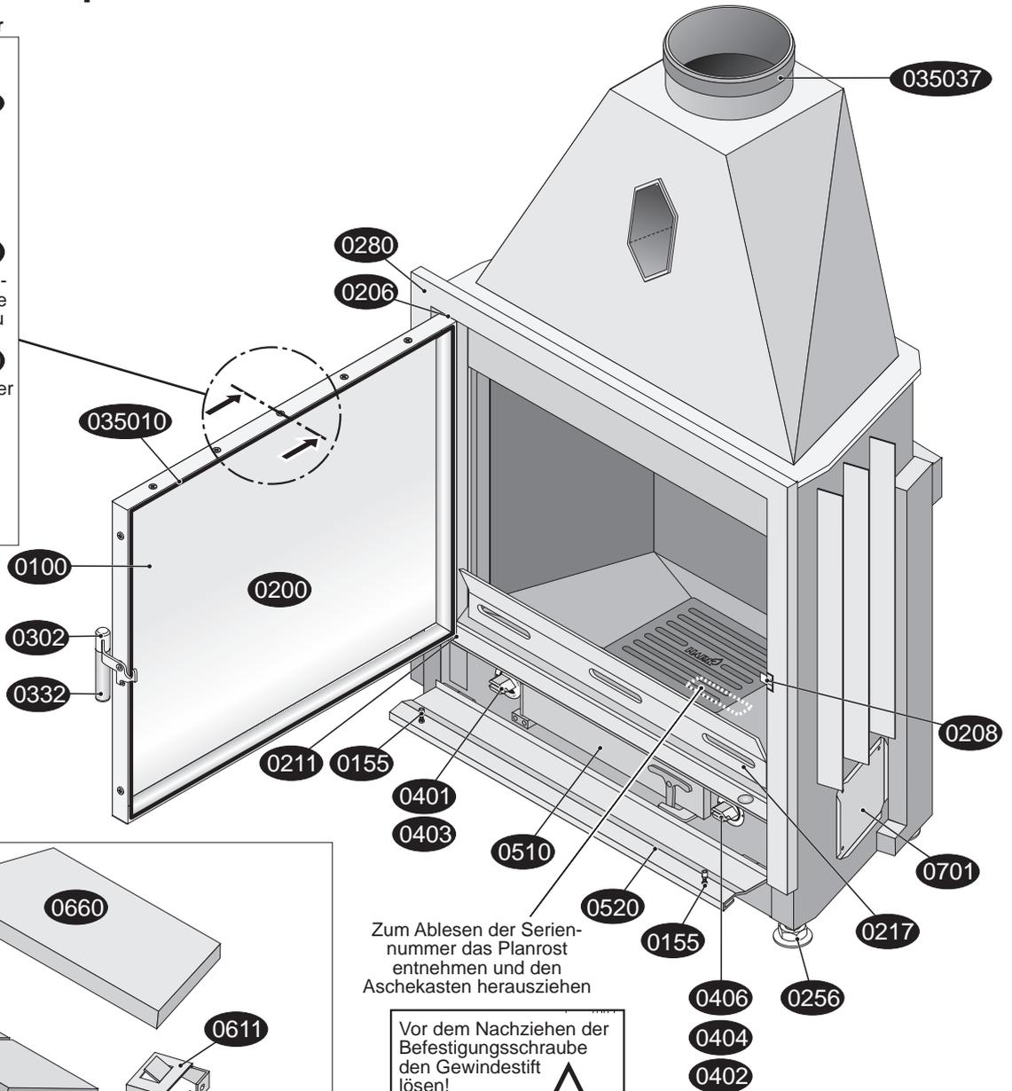
Zum Ablesen der Seriennummer das Planrost entnehmen und den Aschekasten herausziehen
